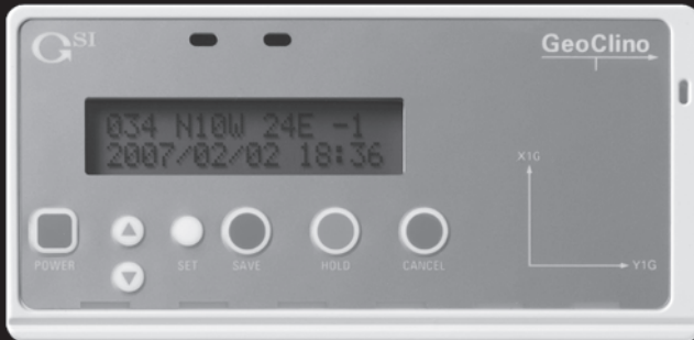
外形寸法：約142×69×26mm 電源：単3アルカリ電池2本で約20時間連続使用可能
