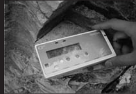
【走向傾斜の測定風景】
